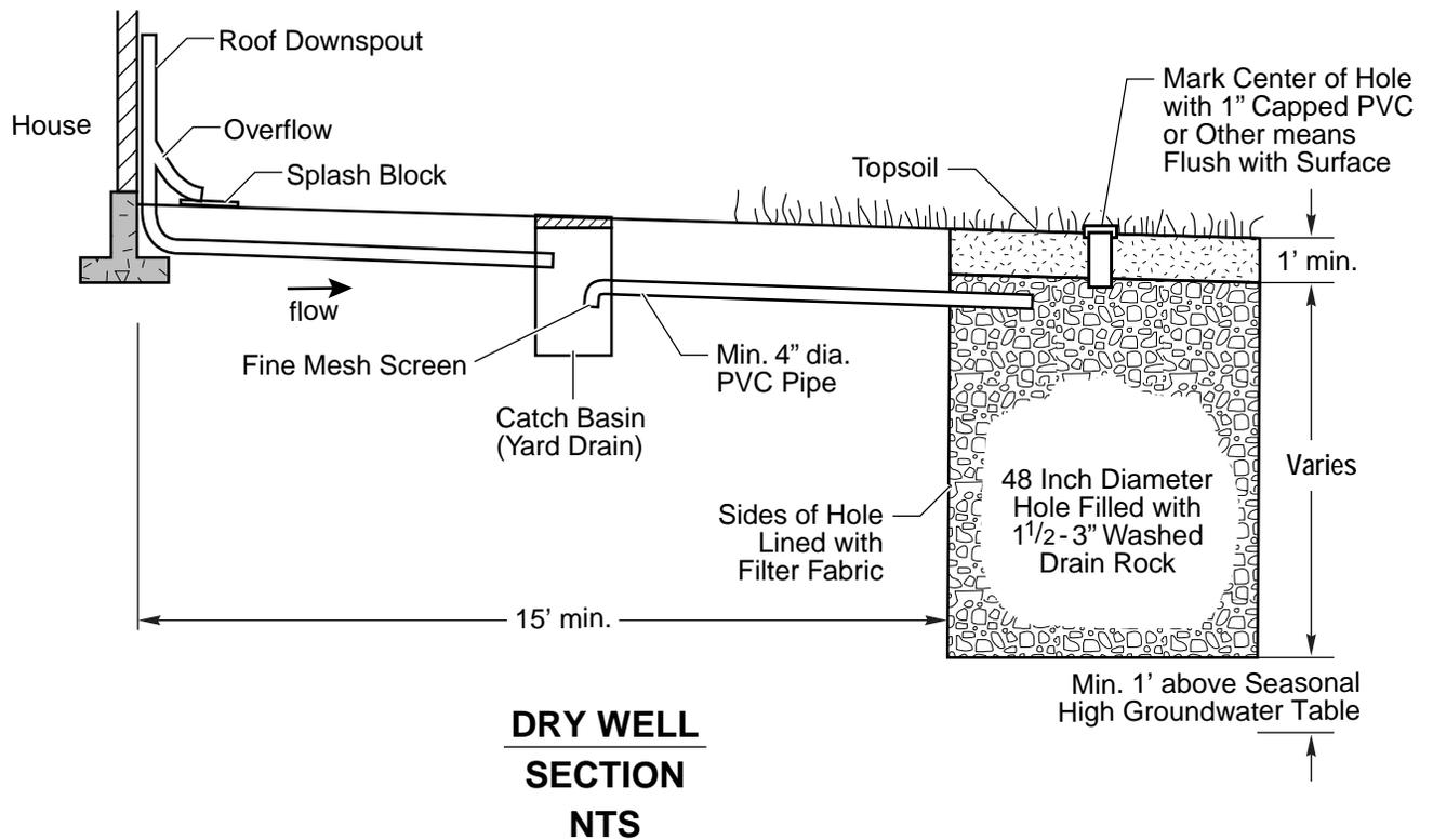
**FIGURE C.2.2.D TYPICAL GROUND SURFACE DEPRESSION INFILTRATION SYSTEM**
