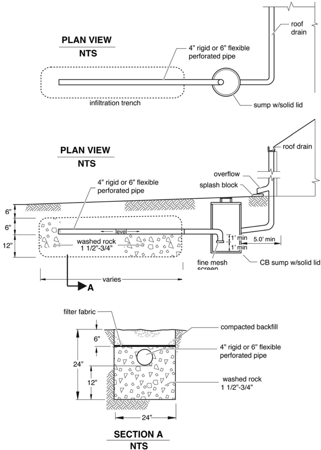
**FIGURE C.2.2.B ALTERNATIVE TRENCH INFILTRATION SYSTEM**
